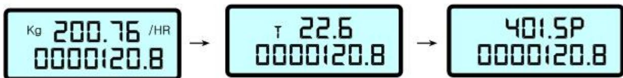
**注：**上排循环显示温度和压力功能可关闭。
